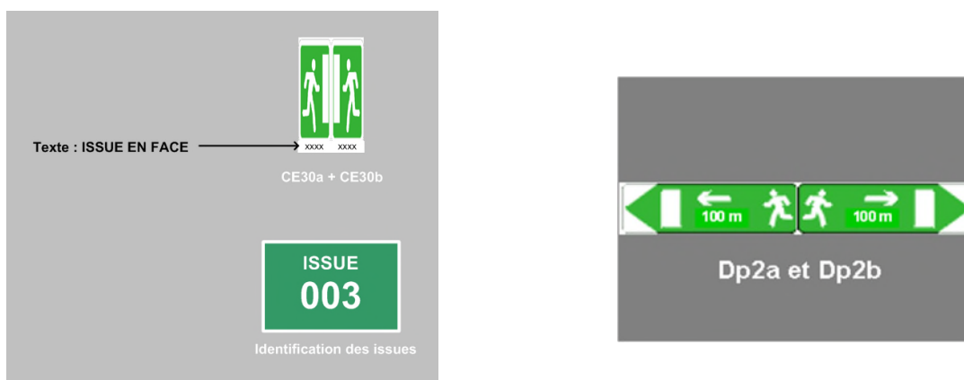
Figure 54: Signalisation des issues sur les deux piédroits
