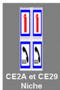
Figure 57: Signalisation des niches de sécurité
